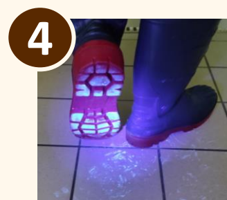
Visualización bajo luz UV de la "contaminación" tras el cambio de zona
